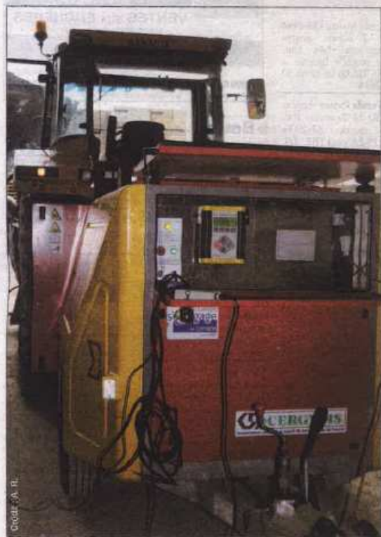
Au cours de la formation, le formateur utilise un banc d'essai tracteur pour bien comprendre la régularité de la puissance et les composantes de la consommation de carburant.
